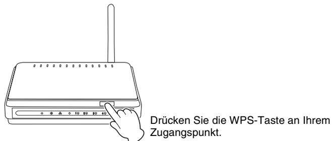
Wenn die Verbindung zum Wireless-Netzwerk hergestellt wurde, leuchtet das LED-Lämpchen des UD-WL01 und blinkt anschließend während der Kommunikation über das Netzwerk. Die erforderlichen Informationen werden automatisch eingestellt, und die Verbindung zwischen Zugangspunkt und Instrument ist hergestellt.
